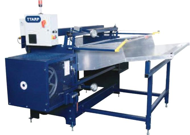
La mesa de alimentación ajustable se puede inclinar hacia arriba para desollar o permanecer plana para dividir
