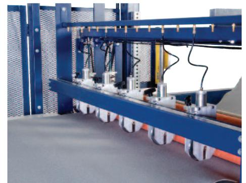
Detalle del ensamble de corte longitudinal
