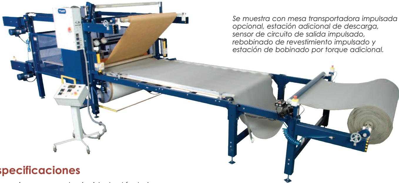
Se muestra con mesa transportadora impulsada opcional, estación adicional de descarga, sensor de circuito de salida impulsado, rebobinado de revestimiento impulsado y estación de bobinado por torque adicional.
