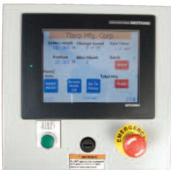
Interfaz de pantalla táctil (se monta en la consola móvil) permite ajustes fáciles y laminado automático de rollos como una opción
